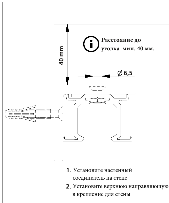
4_ установка крепления для стены
