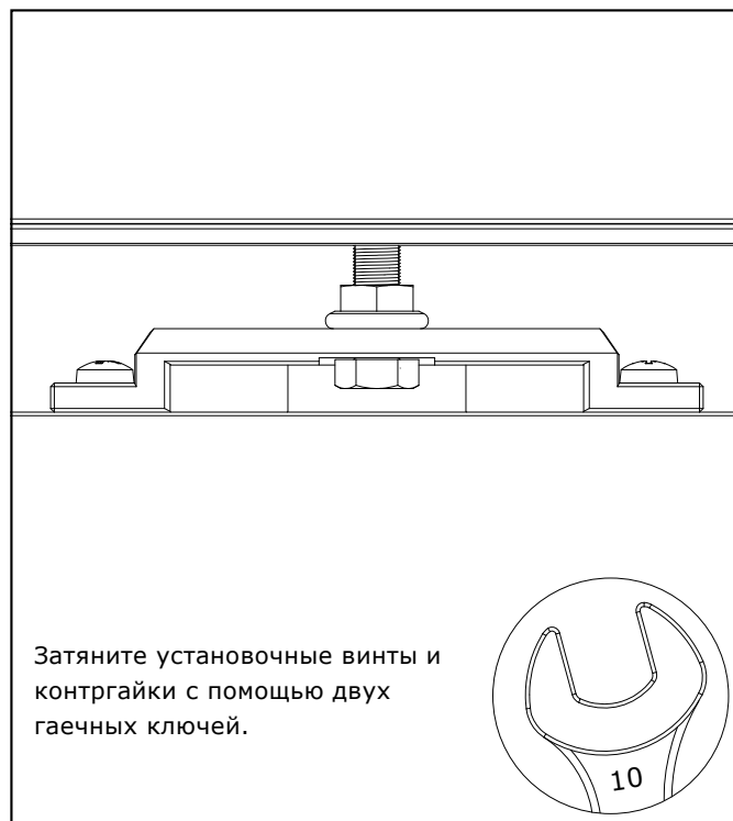
9_ Затяните контргайки на креплении роликов.
