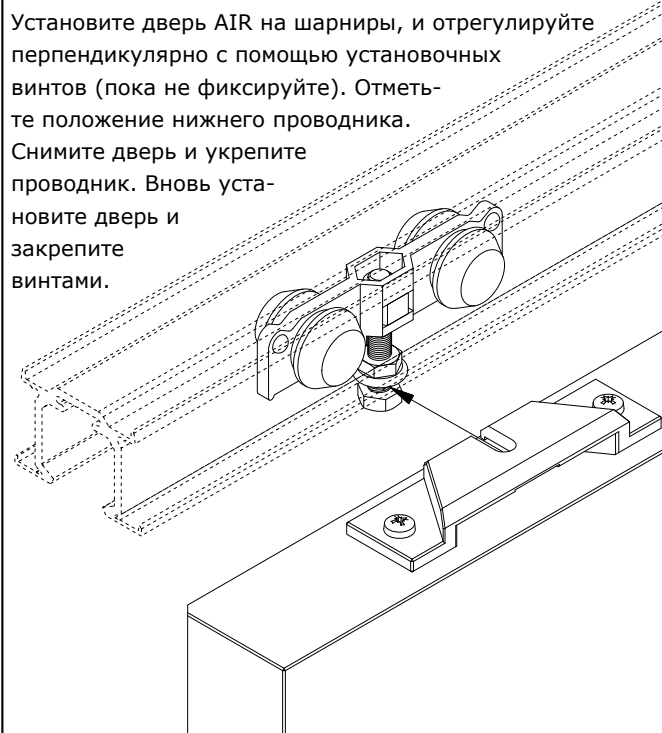
6_ Установите дверь AIR на шарниры.
